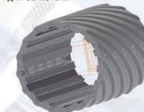
РИС. 10. Распечатанный на 3D-принтере прототип направляющего турбулизатора
