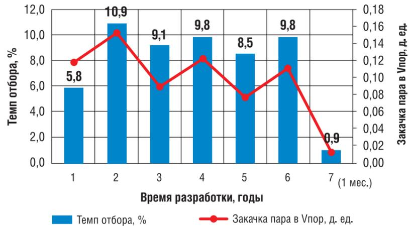
На рисунке 9 представлена динамика темпов нефтеотдачи в целом по опытному блоку, где видно, что уже на второй год разработки достигнут достаточно высокий темп нефтеотдачи.
