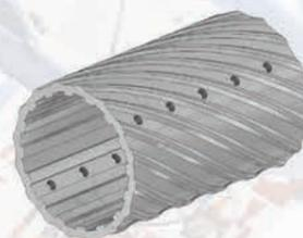
РИС. 9. Сеточная модель направляющего турбулизатора для 3D печати
