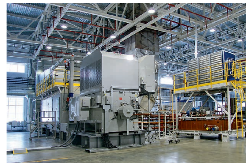
ФОТО 2. Испытания газотурбинной установки ГТА-16 на стенде «ОДК – Газовые турбины»
