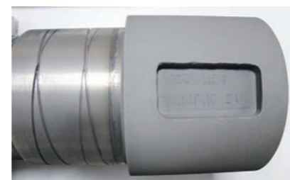
РИС. 3. Покрытие из WC/Co/Cr на восстановленной замковой части
