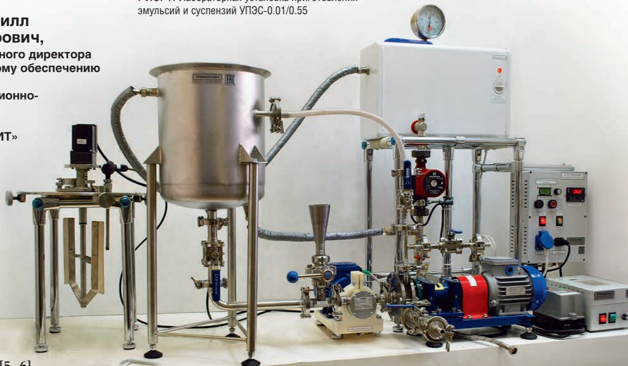
РИС. 1. Лабораторная установка приготовления эмульсий и суспензий УПЭС-0.01/0.55
