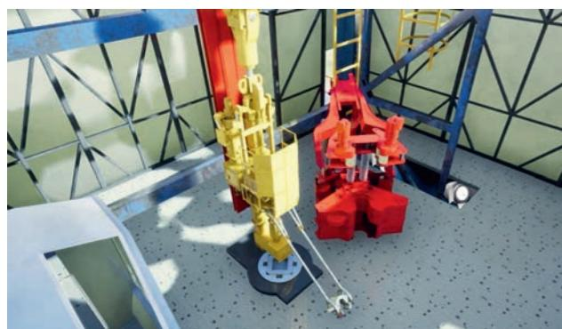
РИС. 4. Силовой верхний привод
