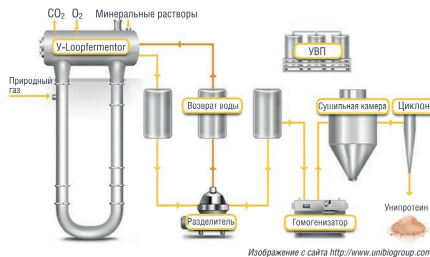
РИС. 5. Основной аппарат в производстве Гаприна
