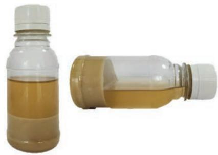
слой жидкости достаточной толщины. Пример нестабильной суспензии, формирующей плотную упаковку, изображен на рисунке 2. Видно, что осевший полимер не возвращается во взвешенное состояние при переворачивании емкости – такую суспензию затруднительно диспергировать повторно.
