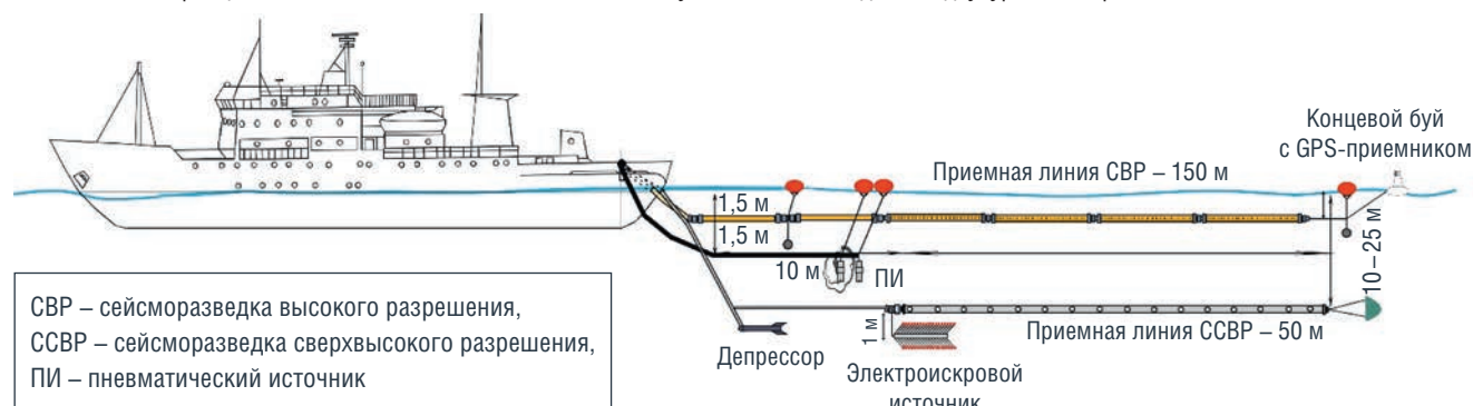
РИСУНОК 2. Принципиальная схема многоканальных сейсмоакустических наблюдений с двухуровневой расстановкой
