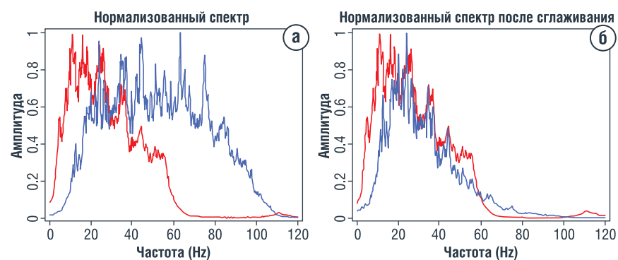
РИСУНОК 6. Приведение спектров для суммирования: (а) – спектры до балансировки; (б) – после балансировки (Greer and Fomel, 2018)
