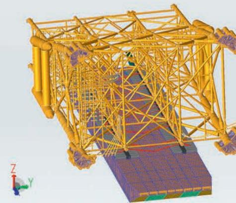
SNC-Lavalin использовала продукты SACS и STAAD.Pro и благодаря им завершила разработку несущей конструкции в кратчайшие сроки. С помощью различных модулей решения SACS специалисты провели 19 исследований, включающих анализ волновых нагрузок в условиях шторма, сейсмических реакций, выносливости конструкции, морской транспортировки и влияния случайных факторов. Единая программная среда обеспечила эффективный обмен информацией и совместное моделирование несущей конструкции и верхних сооружений.
