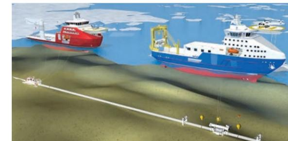
Очевидно, что в обустройство месторождения входит целый ряд различных работ, в том числе: прокладка трубопроводов, установка стационарных и плавучих сооружений, которые осуществляется специализированными судами-трубоукладчиками и краново-монтажными судами, но кроме того, при строительстве и обустройстве морских месторождений выполняется большое количество сопутствующих подводных работ:
