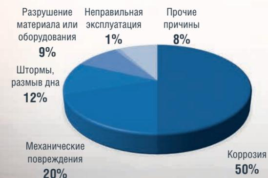
РИС. 2. Распределение отказов в жизненном цикле морских трубопроводов
