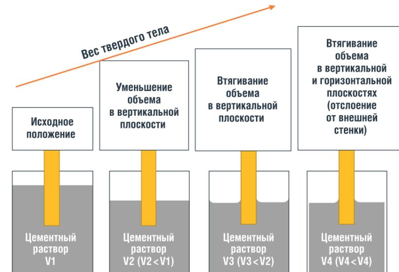
РИС. 8. Схема процессов, оказывающих влияние на изменение веса твердого тела в формирующемся цементном камне при наличии столба воды над цементным тестом
