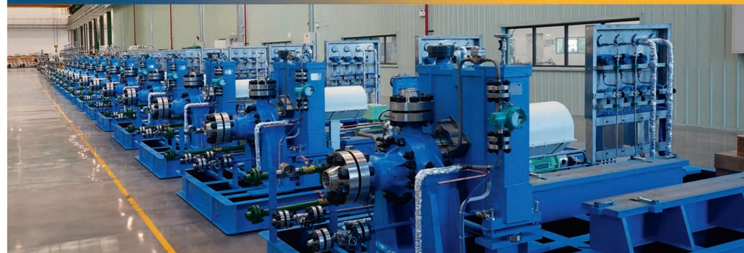
**Высокоскоростной центробежный насос со встроенным редуктором (API 610 OH6)**
