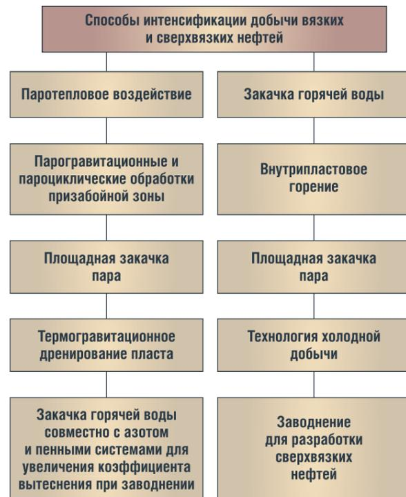
На схеме (рисунок 1) приведены основные способы термического воздействия на призабойную зону пласта (ПЗП).
