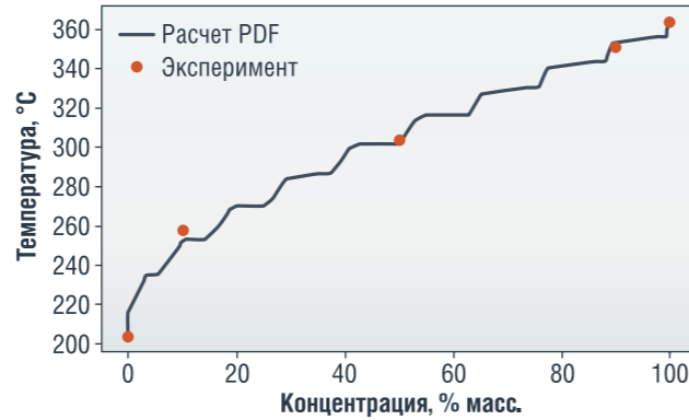
РИСУНОК 44. Рассчитанные и экспериментальные данные по фракционному составу
