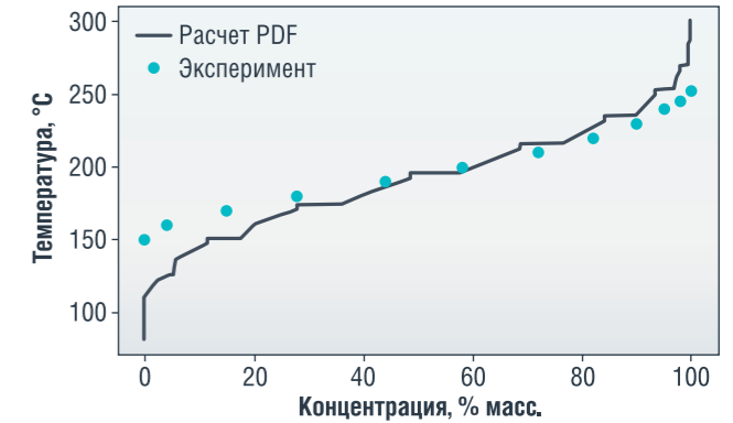
РИСУНОК 51. Рассчитанные и экспериментальные данные по фракционному составу
