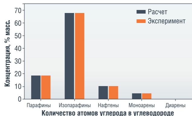
РИСУНОК 16. Рассчитанные и экспериментальные данные по групповому составу
