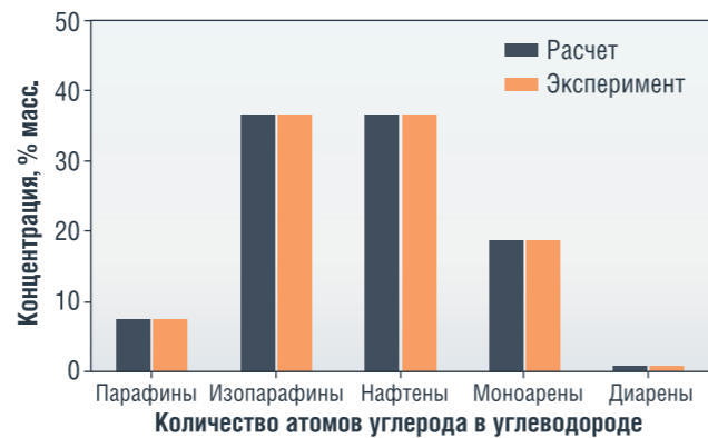
РИСУНОК 30. Рассчитанные и экспериментальные данные по групповому составу
