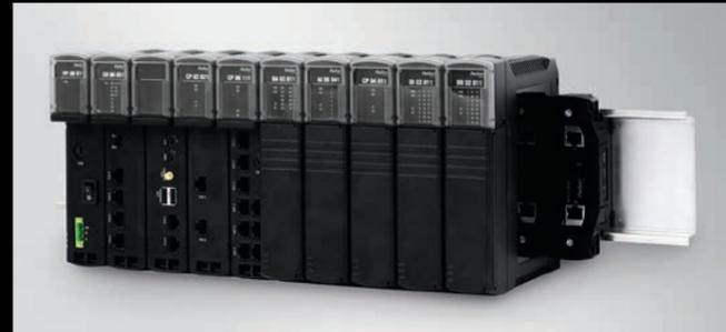
Контроллер REGUL R500 предназначен для построения ответственных, отказоустойчивых и распределенных систем АСУ ТП в различных отраслях промышленности.
